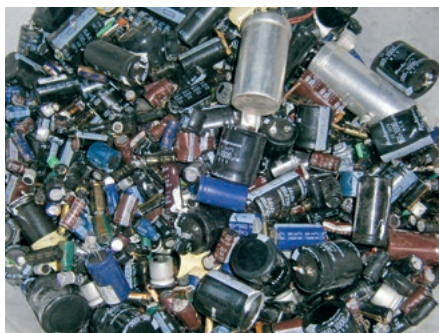
Condensateurs après démantèlement manuel
