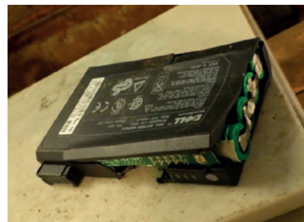
PLI défectueuses issues des essais par lots Swico: a) cellules individuelles, b) batterie Laptop
