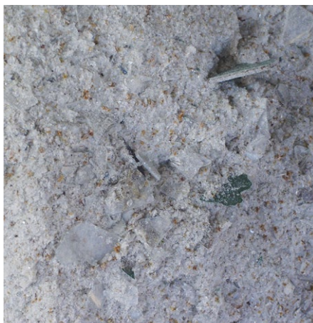
Illustration 4: Poudre luminescente en vrac, issue du traitement des lampes à décharge gazeuse: il s'agit d'un mélange de verre, de mercure, de terres rares et d'impuretés diverses
