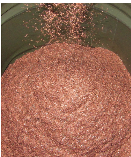
Illustration 2: Granulat de cuivre issu du traitement des câbles
