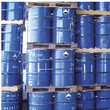
Illustration 3: Récipients contenant de la poudre luminescente, préparés par un récupérateur allemand pour être entreposés définitivement dans une mine de sel souterraine (2010)
