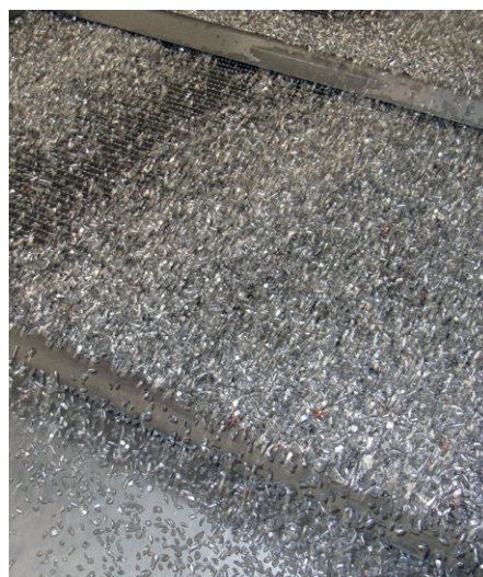
Illustration 3: Granulat d'aluminium issu du traitement des câbles
